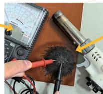
電気スパーク等の高いエネルギーによりグラファイト化することに対し、建物火災等の最高温度1100℃~1200℃の熱では条件が揃わないとグラファイト化しない。
