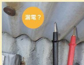
漏電した可能性のある箇所が電気を通す素材(導体)なのか、まずは導通チェック!
