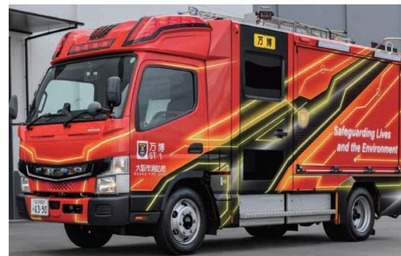
EVシャシにモーターとポンプを架装し、走行用バッテリーを動力源として、ポンプを駆動させるEVポンプ車。ボールコックはすべて電動で、ポンプ室操作盤に加え、タブレットでの無線操作が可能。900L水タンク・左右貫通資器材庫・5本積みホースカー及び昇降装置・梯子昇降装置・吸管巻取装置を備える。
