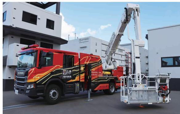
バスケット付き21mブーム（屈折+伸縮）・水路管・水ポンプ・CAFS\*・900L水タンク・および資器材収納庫を備える。バスケットは車いす・ストレッチャーに対応。屈折ブームを使用すると、地上揚程21m/地下揚程2mの範囲で活動が可能。消火・救助・資器材収納と多目的に活動できる車両。
