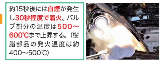
約15秒後には**白煙**が発生し**30秒程度で着火**。バルブ部分の温度は**500~600℃**まで上昇する。(樹脂部品の発火温度は約400~500℃)
