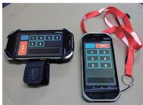
写真 可搬式制御機器（消防庁資料より） （左：腕バンド 右：首掛けストラップ）
