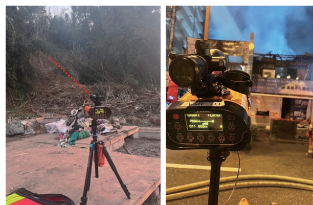
写真2 建物崩壊・土砂監視センサー
