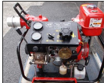
前面カバーを外した状態
