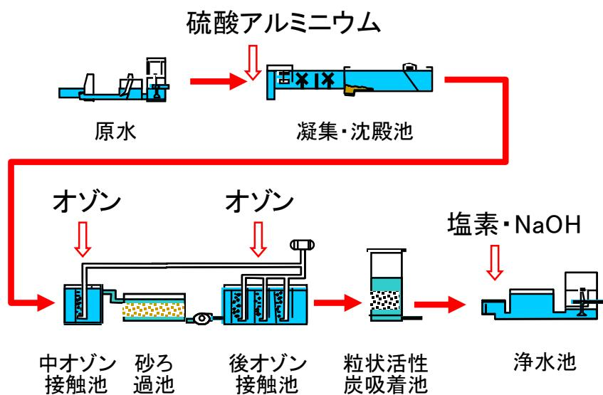
図1.2 高度净水処理フロー図
