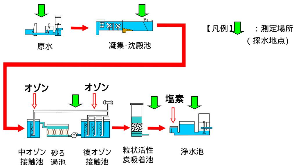
図7 浄水水質管理のための測定場所
