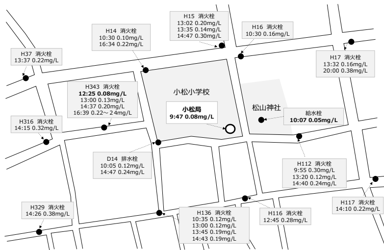
図 - 1 平成 29 年 12 月 14 日の小松局周辺地域の残留塩素濃度
