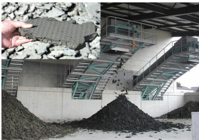
【無薬注方式長時間型加圧脱水設備導入による発生土及び電力削減量】
