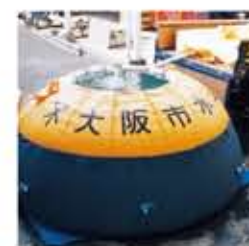
仮設水槽(4t)
