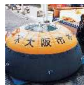
仮設水槽(4t)
