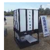
仮設水槽(1t)
