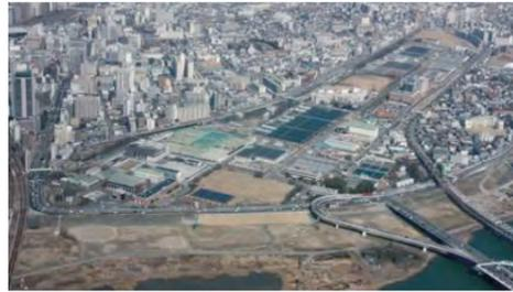
第2回水道拡張事業により、大正3年2月から、給水能力151,800m<sup>3</sup>/日の緩速ろ過設備による通水を開始しており、本市における現存施設としては一番古い浄水場である。その後、第4回水道拡張事業で第1急速ろ過場、第5回水道拡張事業において第2急速ろ過場を建設、さらに、昭和44年から着手した第9回水道拡張事業では、緩速ろ過設備を廃止して、新たに第3、第4急速ろ過場を建設し、現在の給水能力は1,180,000m<sup>3</sup>/日、敷地面積は約462,000m<sup>2</sup>となっている。淀川上流側を上系、下流側を下系として、原水を東淀川区柴島地先の淀川右岸から自然流下で取水するとともに、摂津市一津屋地先の淀川右岸にある一津屋取水場で取水し、ポンプ圧送で導水している。浄水処理を行った後、ポンプ圧送により西部幹線など13幹線を通じて市内中・北・西北部に給水している。
