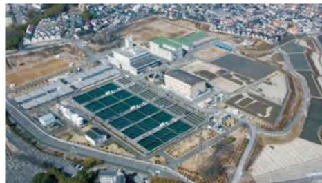
第8回水道拡張事業により昭和43年7月から200,000m<sup>3</sup>/日の一部通水を行い、昭和44年9月から400,000m<sup>3</sup>/日の通水を開始した本市で一番新しい浄水場である。その後、第9回水道拡張事業で増強を図り、現在の給水能力は450,000m<sup>3</sup>/日、敷地面積約180,000m<sup>2</sup>となっている。原水は、約15km離れた枚方市楠葉中之芝地先の淀川左岸にある楠葉取水場で取水し、ポンプ圧送により導水している。浄水処理を行った後、城東配水場へ自然流下(高低差約37m)により送水し、自然流下とポンプ圧送を併用して、船場、長堀、新今宮の3幹線を通じて市内中・東部に給水している。また、当初から制御用電子計算機の導入を行い、中央管理室での遠隔監視制御を行っている。
