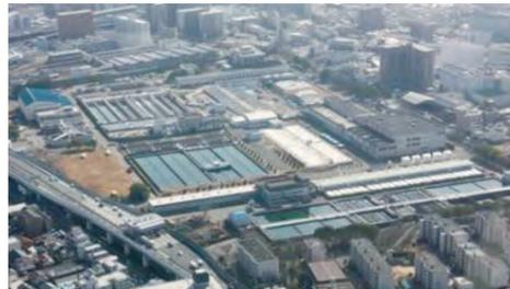
第6回水道拡張事業により、昭和32年11月から給水能力120,000m<sup>3</sup>/日の一部通水を開始し、昭和33年7月から給水能力240,000m<sup>3</sup>/日の全量通水を行った本市2番目の浄水場である。浄水方法は通水当初から急速ろ過方式を採用している。その後、第7回及び第8回水道拡張事業を経て、現在の給水能力は800,000m<sup>3</sup>/日、敷地面積約220,000m<sup>2</sup>となっている。原水は、守口市大日町地先及び大庭町地先の淀川左岸から自然流下で取水し、浄水処理を行った後、大淀配水場並びに箕配水場に送水し、ポンプ圧送によって大淀配水場から浪速・大正の2幹線を通じて市内中西部に、箕配水場からは住吉・南部・新南部の3幹線を通じて市内南部に給水している。また、本市では初めて集中管理方式を取り入れた浄水場である。
