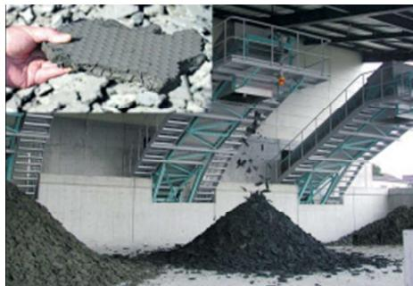
加圧脱水方式(庭窪浄水場)
