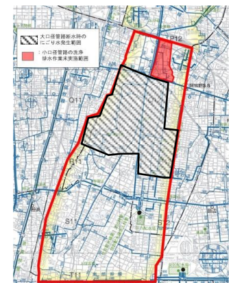
図-7 にぎり水発生予測範囲及び事前洗浄排水作業範囲
