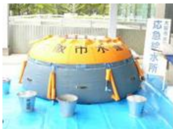
バルーン式仮設水槽 (4m 3 )
