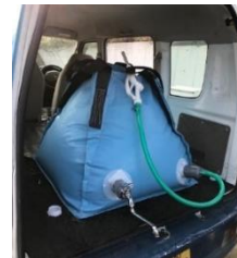
車載型給水タンク
