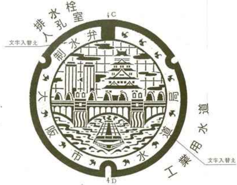
4号(600) 呼び径φ600以上の制水弁用 双口排水栓用、人孔室用模様
