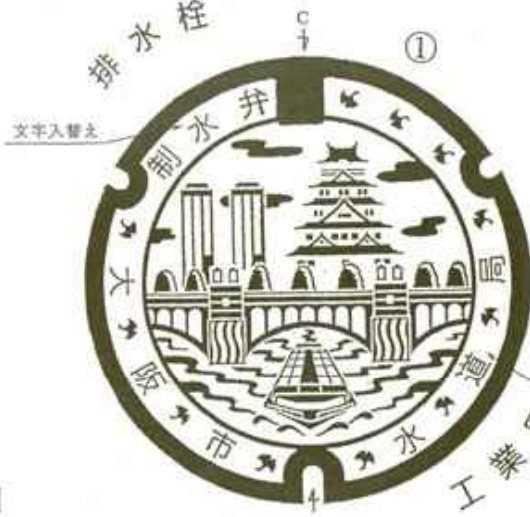
3号(500) 呼び径φ400~500の制水弁用 単口排水栓用模様
