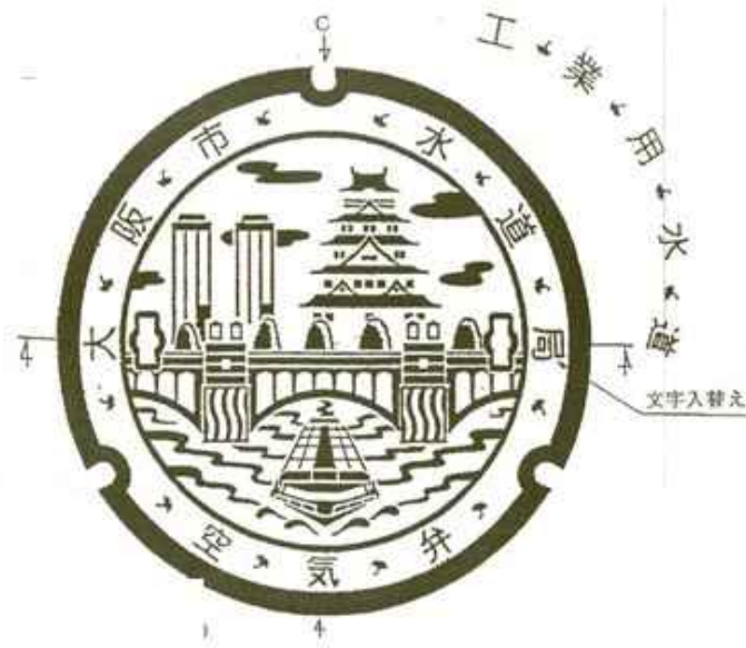
橋梁添架部(500) 急速空気弁(橋梁添架部)用模様
