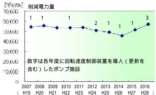
回転速度制御装置の導入による電力削減量
