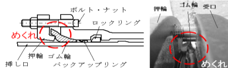
図 接合不良の例
