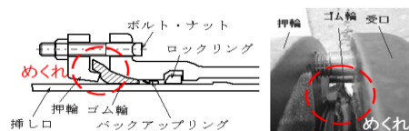
図 接合不良の例
