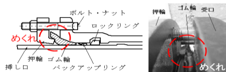
図 接合不良の例
