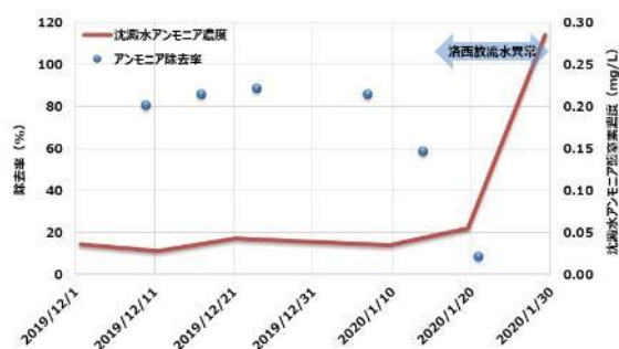
図-12 柴島浄水場新実験施設でのアンモニア処理性（沈澱水→GAC）
