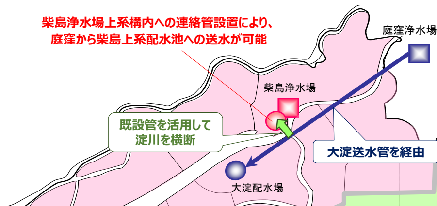
図表3-5 庭窪浄水場から柴島浄水場上系配水施設への送水連絡管の整備効果
