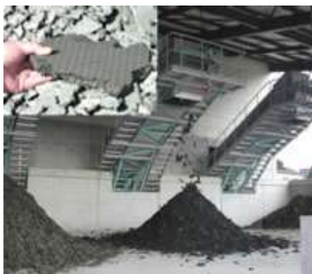
〈機械脱水による浄水発生土(庭窪浄水場)〉 【見直し後】
