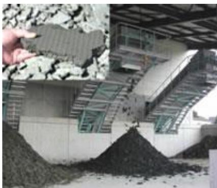
〈機械脱水による浄水発生土(庭窪浄水場)〉
