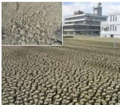
〈天日乾燥による浄水発生土(豊野浄水場)〉
