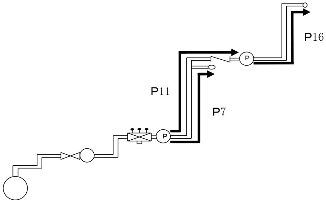
図 2 - 2 4 増圧装置設定圧力選択図
