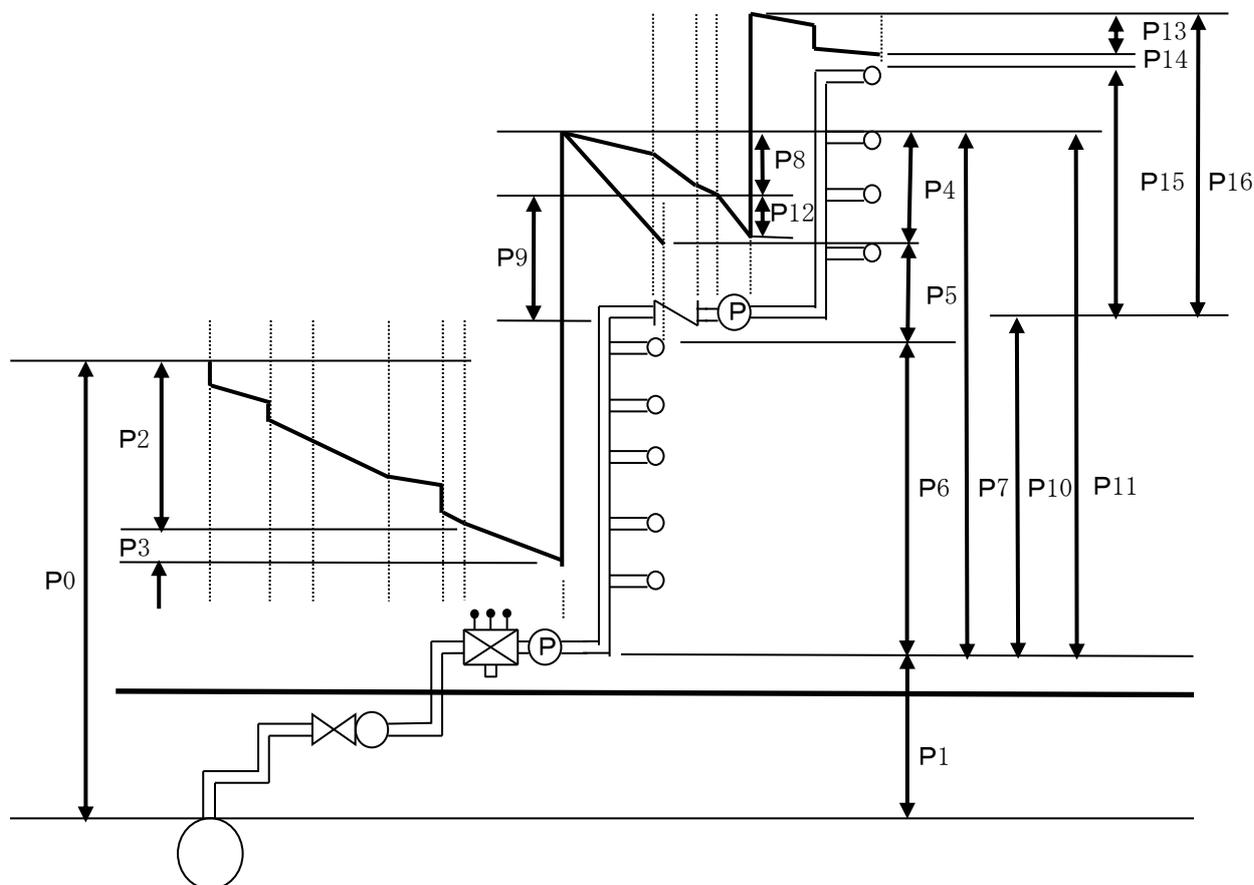
図 2 - 2 3 直結増圧直列多段式給水の動水勾配線図
