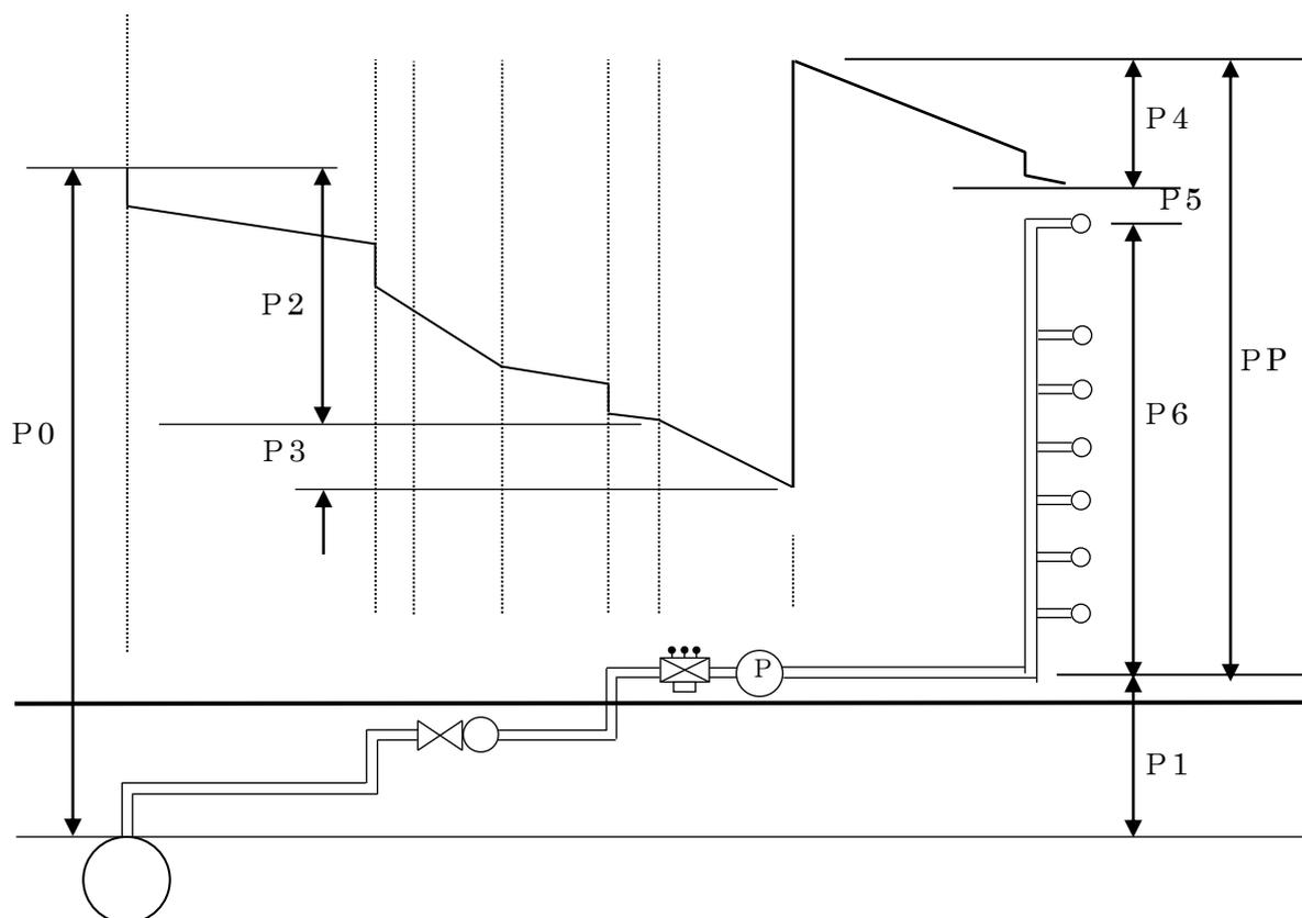
図 2-22 直結増圧式給水の動水勾配線図
