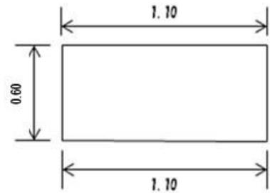
図 2-31 給水装置工事道路掘削標準図 (単位m)
