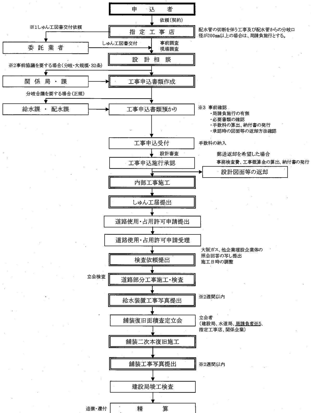
図2-42 標準的な給水装置工事の事務の流れ
