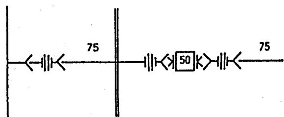
図 2-44 給水管の口径をもってメータ口径とするもの
