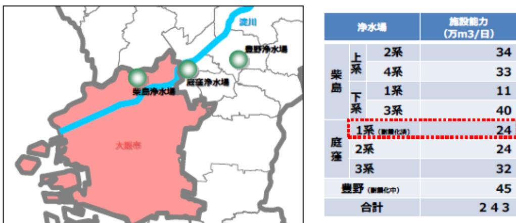
図表2-4 浄水場の施設配置図及び浄水系統・施設能力
