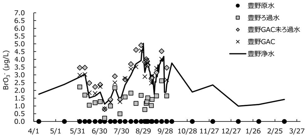
図-4 豊野系処理過程の臭素酸濃度
