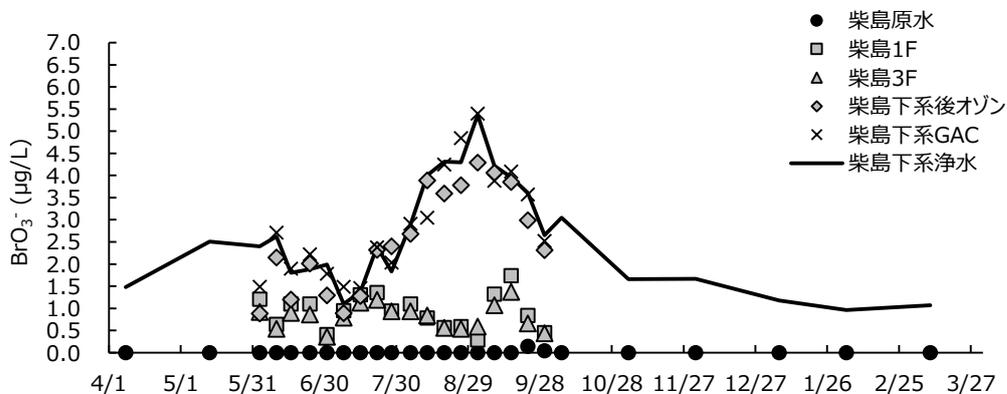
図-1 柴島下系処理過程の臭素酸濃度
