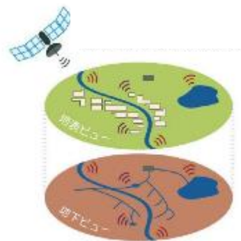
衛星画像解析により 市全域から地下漏水の 発生位置を把握
