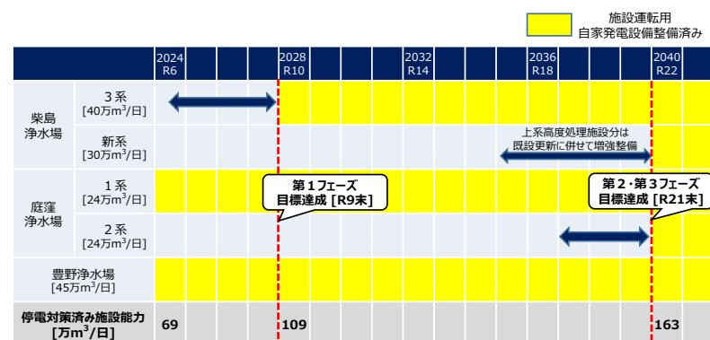
図表 28 取・浄水施設における施設運転用自家発電設備の整備工程
