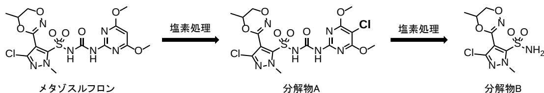
図-6 メタゾスルフロンの推定分解経路と分解物の推定化学構造
