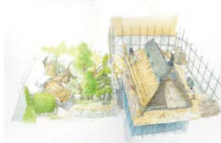
茅屋根葺き替え作業風景
