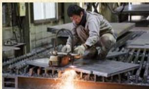
切断したい部分をガストーチで溶かし、高圧酸素を吹きかけて溶断していく。
