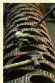
自動車やコンクリート材をも砕く巨大破砕機のプレート。鋼鉄でコーティングし強度を高める。
