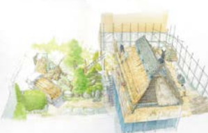
茅屋根葺き替え作業風景
