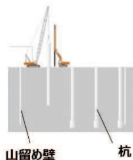
①山留・杭工事
