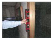
水平器による柱の傾きの計測
