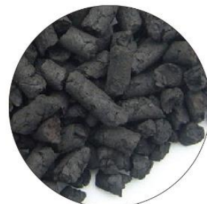
下水汚泥から生成した炭化燃料
