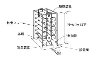
駆動装置が梁上に突出する場合の Hは、鉄骨フレームの設置面から 駆動装置の上端までとする。
