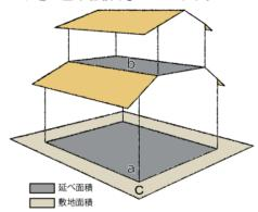
容積率 =  $\frac{$ 延べ面積 (a + b)}{ 敷地面積 (c)} ×100 (%) ≤ 容積率の限度
