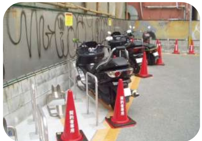
省スペースのために前輪を固定し直立させる仕組み
