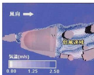
冬期卓越風の風況解析結果(平面)
