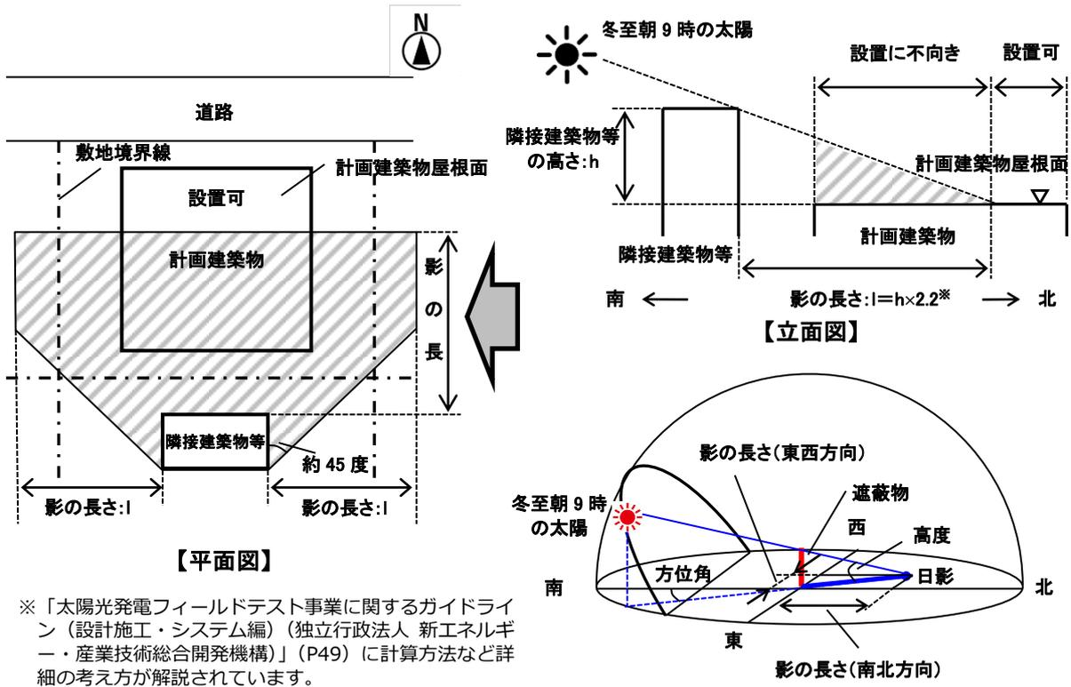
太陽光発電設備の本格導入にあたって、日射遮蔽物がある場合等において日照条件を詳細に確認する際には、日影計算に使用する専用ソフト等を使用して計算する必要がありますが、導入検討の段階では簡易な作図による方法でも支障ありません。
