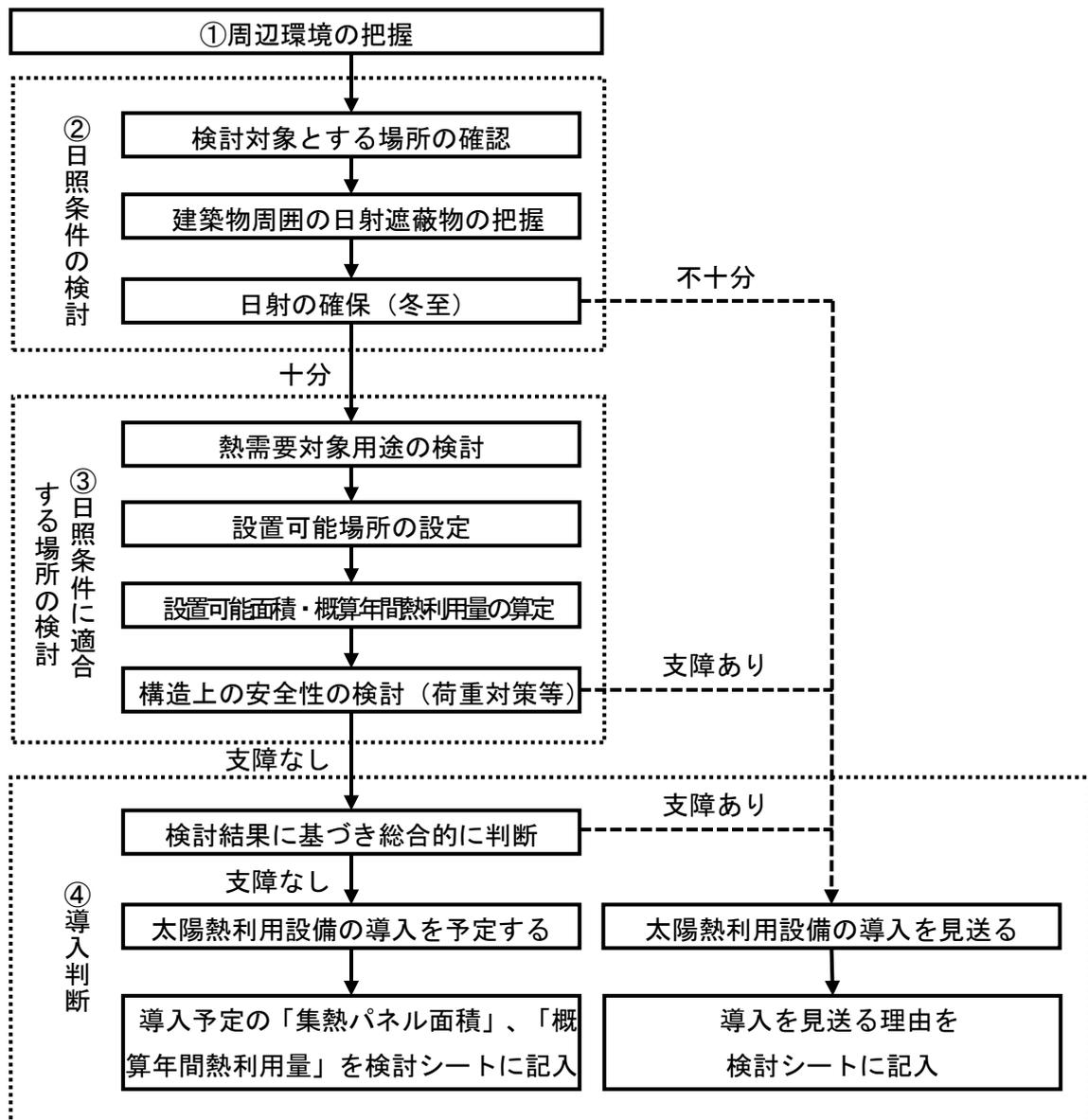
図 5 太陽熱利用設備の導入検討フロー
