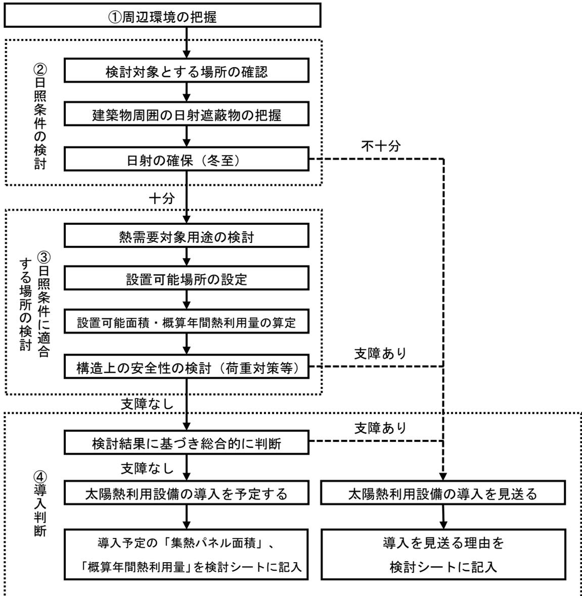
図6 太陽熱利用設備の導入検討フロー
