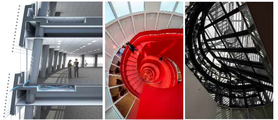
図1: 自然の風と光を導く仕組み (窓廻り断面/エコシリンダー/排気窓と導光装置)
