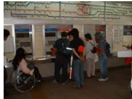
券売機の蹴込みがない(例)
