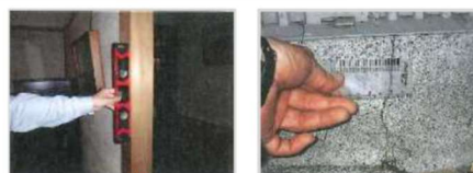
水平器による柱の傾きの計測
