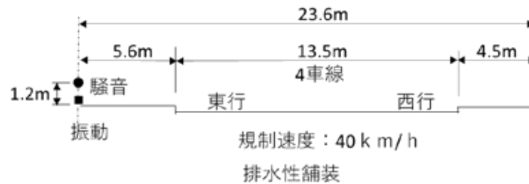
図 6.5.3(1) 道路断面状況と測定機器配置位置 ( 1 )
