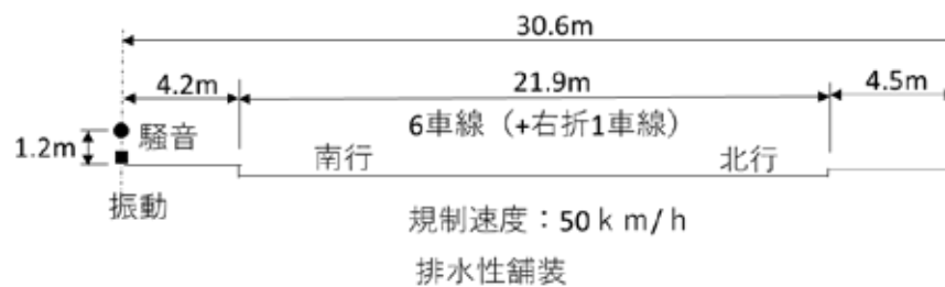
図 6.5.3(2) 道路断面状況と測定機器配置位置 ( 2 )
