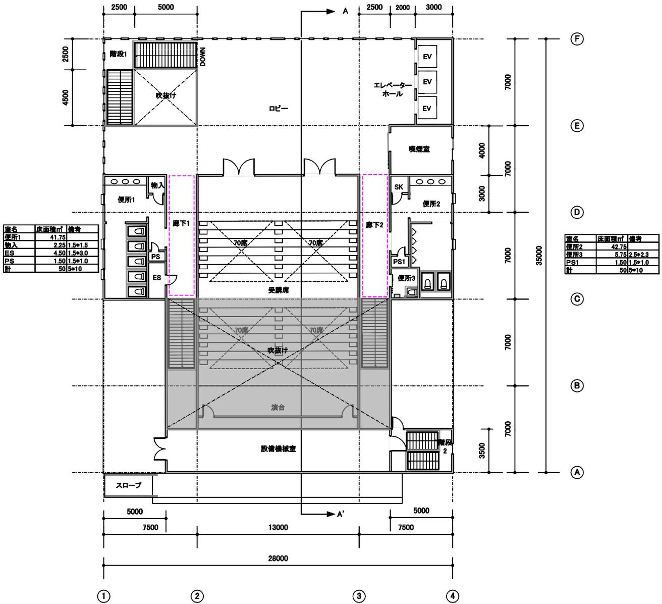
モデル建物（大学\_低層棟、1,648.5㎡） 2階平面図 1/200
