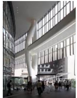
上/北館「ナレッジプラザ」は天 空光による自然採光、テナン ト空調排気再利用、居住域空 調、トップライト排気（夏）、 同デリバントファンによる暖 気吹下し（冬）を行っている。
